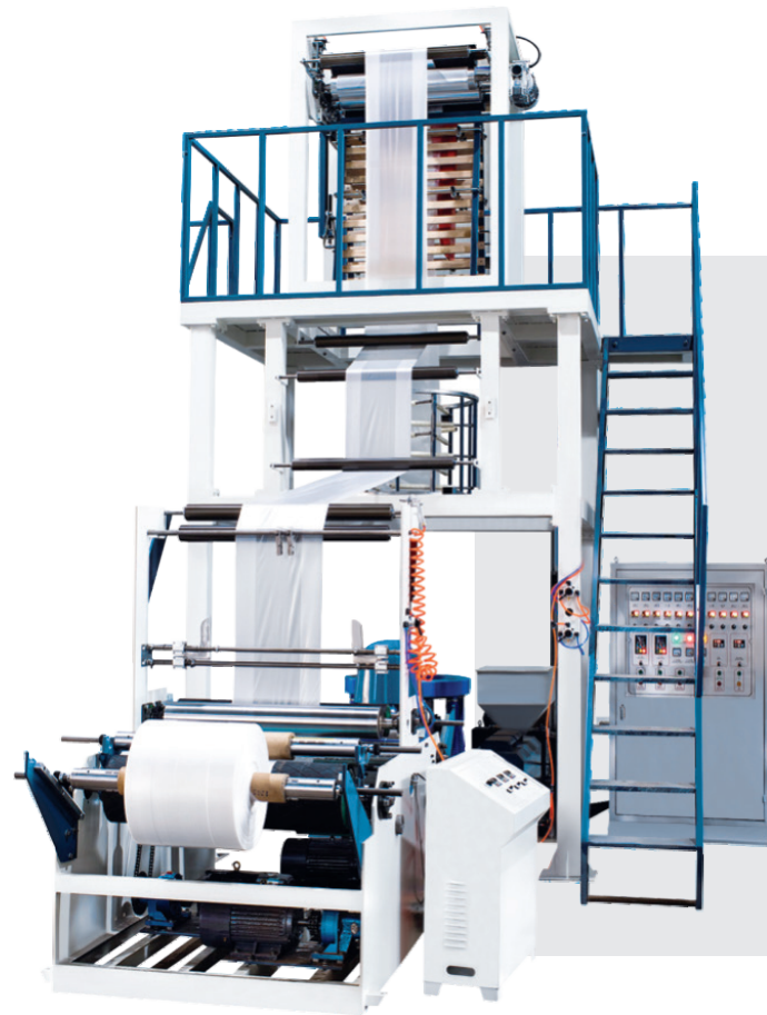
Máquina de soplado de películas de alta velocidad QS-A-H50/55/60/65
